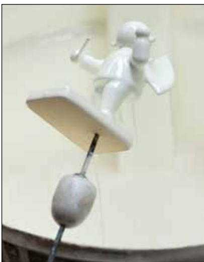
Vor der Bemalung werden die Figuren in der Taucherei zunächst zwei Mal weiß grundiert und anschließend lackiert. Foto: Uwe Meinhold
