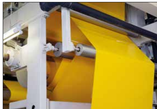
Anlage zum Gießen von PVC-Folie
